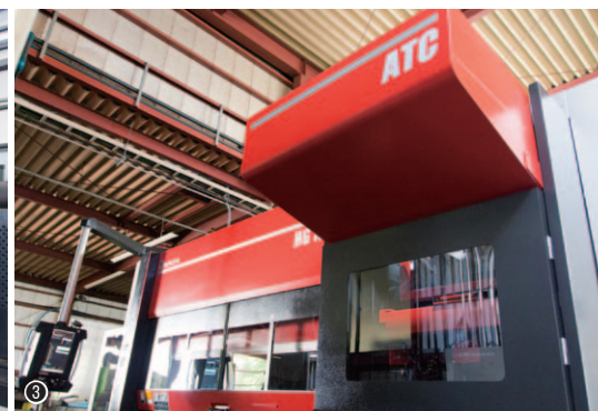
①ファイバーレーザー複合マシンLC-2515C1AJ／②レーザーマシンLC-3015F1NT(6kW、棚付き)が板厚24mmまでの厚板レーザー切断に対応／③第2工場竣工に合わせて導入した金型自動交換装置(ATC)付きハイブリッドベンディングマシンHG-1003ATC
