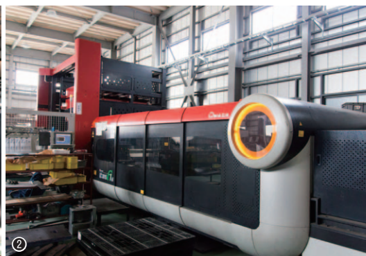
①ファイバーレーザー複合マシンLC-2515C1AJ／②レーザーマシンLC-3015F1NT(6kW、棚付き)が板厚24mmまでの厚板レーザー切断に対応／③第2工場竣工に合わせて導入した金型自動交換装置(ATC)付きハイブリッドベンディングマシンHG-1003ATC
