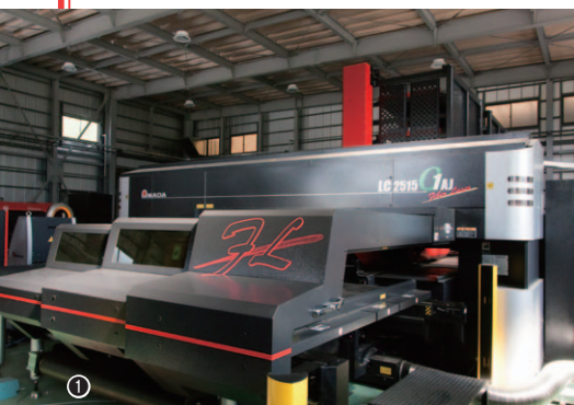
①ファイバーレーザー複合マシンLC-2515C1AJ／②レーザーマシンLC-3015F1NT(6kW、棚付き)が板厚24mmまでの厚板レーザー切断に対応／③第2工場竣工に合わせて導入した金型自動交換装置(ATC)付きハイブリッドベンディングマシンHG-1003ATC
